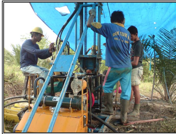
Kegiatan Pemboran Menggunakan Bor mesin Jackro
