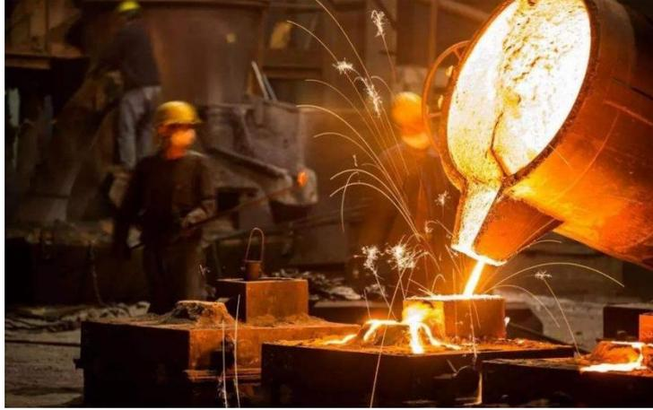
1500 度的铁水，这里是郴州嘉禾古老的铸造城！那这种铸造工艺呢，起源于明末清初。大到起重机的底座，小到煤气灶的灶芯，都是用这种古老的方式铸造出来的！用这种传统工艺铸造出来的铸件呢它的成本是现代工艺的 1/3，而且成品率非常的高。看起来很简单，其实啊非常考验工人的技术。身在铸造的古都，这里的师傅世代围着泥巴转！因为谁的泥巴玩好了呢，谁就能钱多事少离家近，或许这就是古老的铸造得以千年传承最主要的原因吧！
