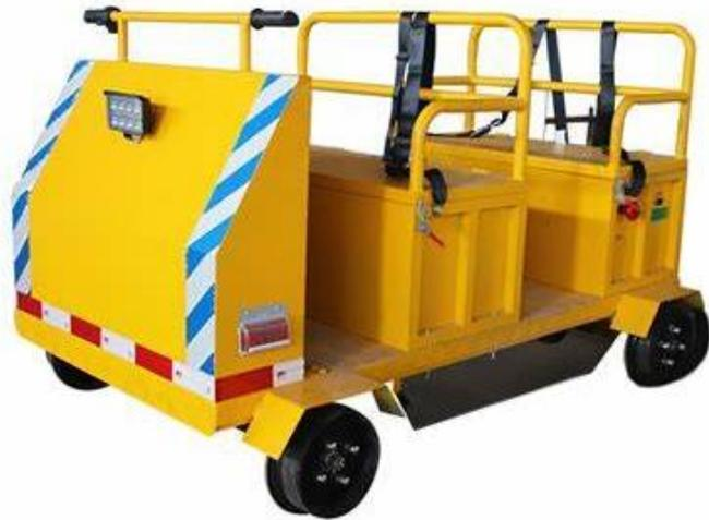
小小的一个扣件松动呢,就可能導致列車的整個脫軌,軌道巡檢關乎 14 億國人的安全。在以前,這可全靠鐵道工人拿着扳手一節一節的敲。而現在,中車時代電子的王炸技術:軌道綜合巡檢小車,讓工人們從此過上了腳不沾地完成巡檢的好日子。別看它這麼簡約,實際上搭載了超多高科技呢!最重要的是,考慮到我們的國鐵和地鐵工人在每次上道前後 都要對小車進行拆裝卸操作。所以這就需要我們對小車進行輕量化的減重。3 個人 5 分鐘完成拆裝。可以充分利用天窗時間進行高效的巡檢工作。檢測精度幾乎等同於最高檢測精度的 0 級軌檢儀。在業內來說,還是相當震撼的~
