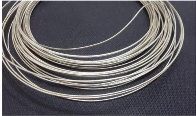
把钻石破碎之后的碎钻颗粒镶嵌在钨丝上，就能以最大 65 米/秒的高速下切割单晶硅片，韧如蒲草又坚如磐石，这个呢就是神奇的金金刚石锯线。除了光伏用的单晶硅片，还有碳化硅片、光学镜头、碳碳等等非金属的超硬材料都是用金刚石锯线切割出来的。
